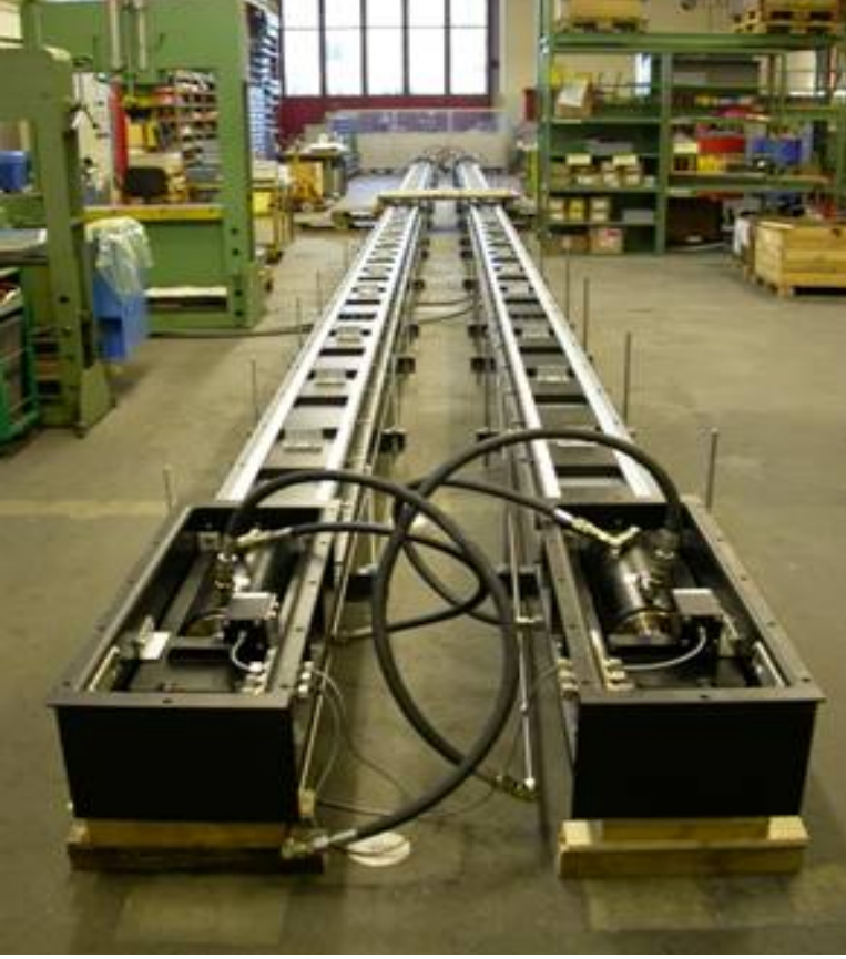
Montaj tesisinde tamamlanmış 25 m uzunluğunda silindirik yıkama ünitesi
